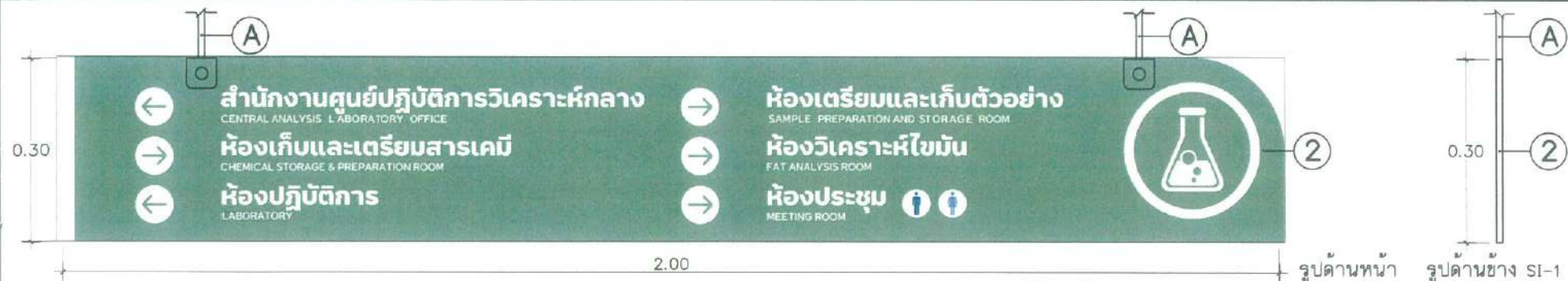
ป้ายห้อง : แบบแขวนจากฝ้าเพดาน IS-1 มาตรฐาน 1 : 10
