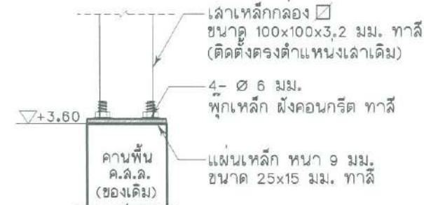
รูปตัด (ตำแหน่งคาน) มาตราส่วน 1:10 A - A
