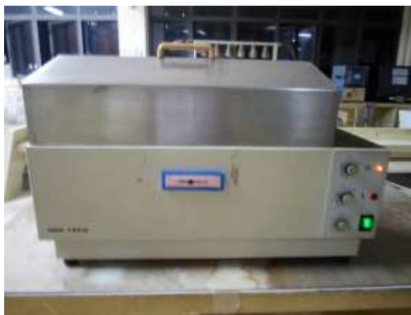
ภาพที่ 18. อ่างควบคุมอุณหภูมิแบบเขย่า Shaking Water Bath
