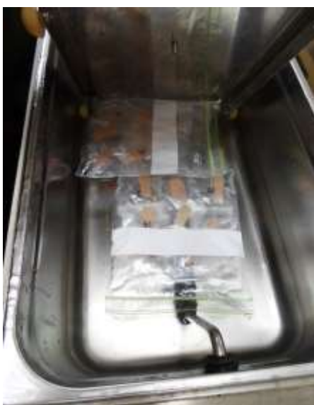
ภาพที่ 15. การวิเคราะห์ Cooking loss และ Shear force
