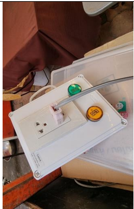
ภาพการใช้งานอุปกรณ์ (อ่านค่ากระแสไฟฟ้าได้ 0.7 แอมป์ (A) 232 โวลต์ (V) )
