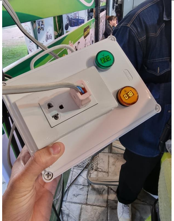
ภาพการใช้งานอุปกรณ์ (อ่านค่ากระแสไฟฟ้าได้ 1.8 แอมป์ (A) 220 โวลต์ (V) )
