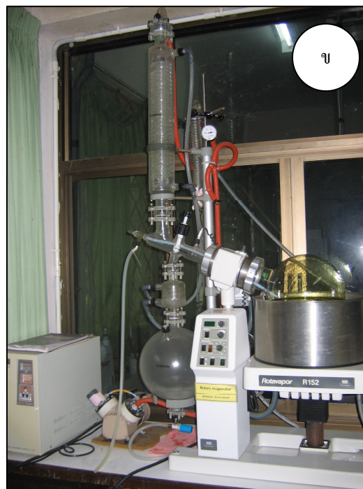
ภาพที่ 5 การแช่เนื้อในเมล็ดสะเดาข้างในขวดแก้วขนาด 20 ลิตร (ก) และเครื่องระเหยสุญญากาศแบบหมุน (ข)
