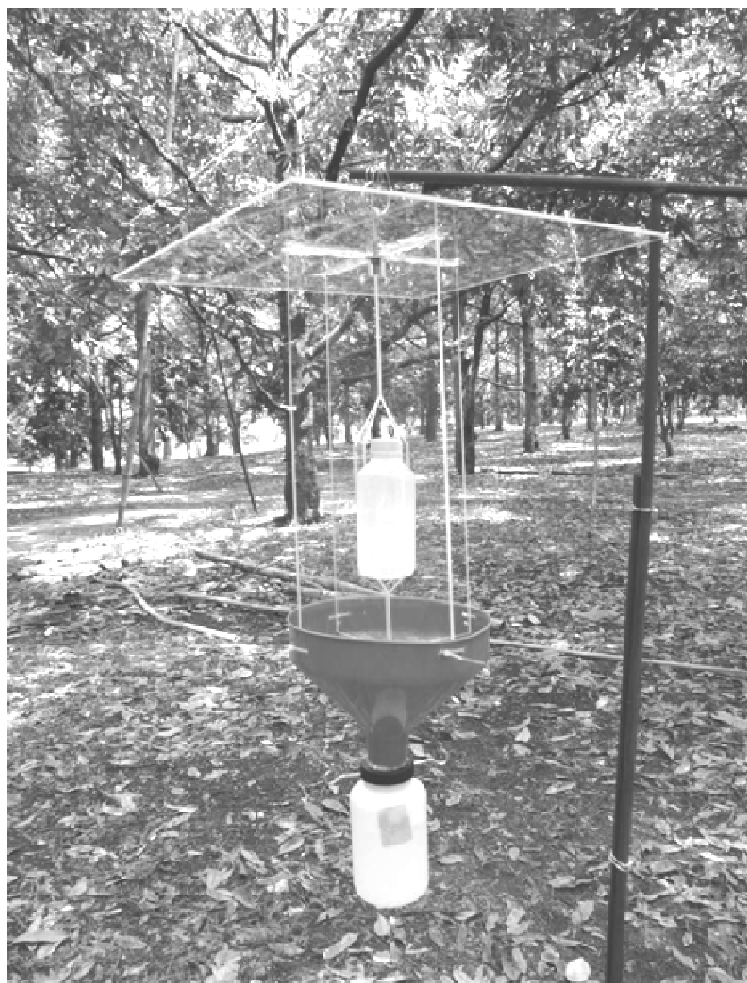
ภาพที่ 3 กั๊บดั๊ก Ethanol-baited trap ดัดแปลงรูปแบบจาก Model ESALQ-84 (Filho and Flechtmann, 1986) ที่ใช้ในการทดลอง
