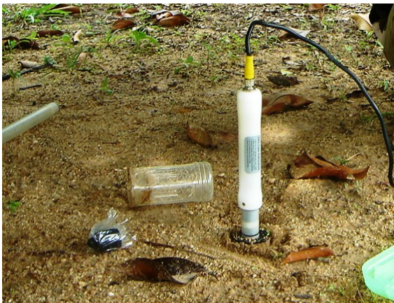
ภาพผนวกที่ 5 การฝังท่อและวัดความชื้นดิน
