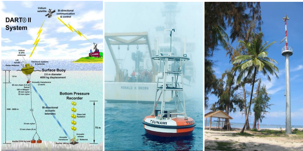
ภาพที่ 8 แสดงระบบการแจ้งเตือนภัยคลื่นสึนามิ (DART) (ซ้าย) ทุนลอยบนผิวน้ำ (Buoy) (กลาง) และ หอเตือนภัย (siren tower) (ขวา)
