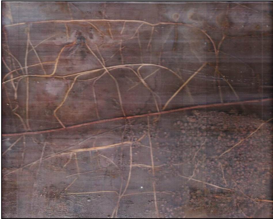
ภาพที่ 15 ผลการบันทึกการเจริญเติบโตของรากยางพาราอายุ 15 ปี ด้วยเครื่อง PSU-Root Scanner 1 ที่ยังไม่ปรับคุณภาพของภาพด้วยซอฟต์แวร์คอมพิวเตอร์
