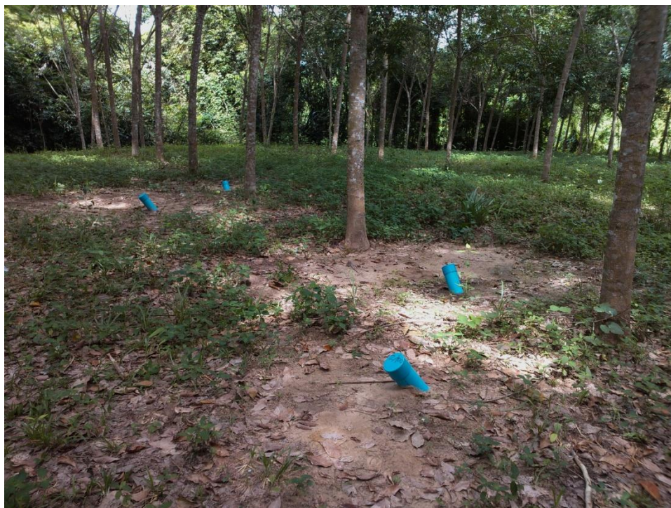
ภาพที่ 3 การติดตั้งท่ออะคริลิกสำหรับ Minirhizotron ในสวนยางพารา
