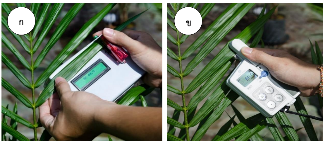
ภาพที่ 13 การใช้เครื่องมือต้นแบบวัดข้อมูล (ก) เปรียบเทียบกับเครื่องคลอโรฟิลล์มิเตอร์ SPAD-502 (ข) ในการประเมินปริมาณคลอโรฟิลล์และปริมาณไนโตรเจนในใบปาล์มน้ำมัน
