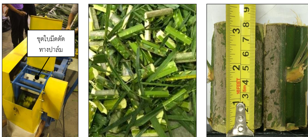
ภาพที่ ข. 7 ลักษณะทางปาล์มจะถูกลดขนาดด้วยชุดใบมีดย่อยทางปาล์ม
