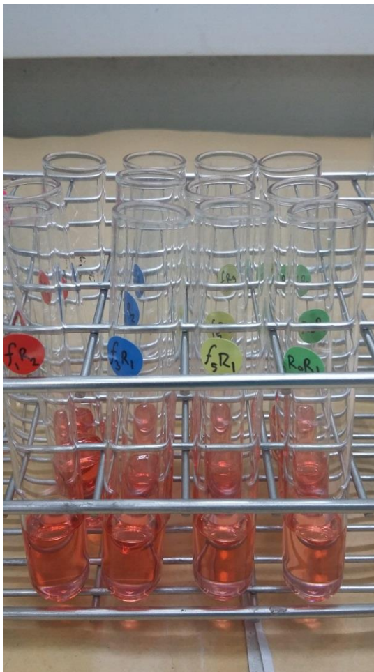
รูปที่ 18 การวัดปริมาณโพรลีนในใบต้นกล้าปาล์มน้ำมันหลังจากเติม toluene
