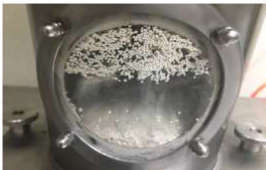
ภาพภาคผนวกที่ 2 การขึ้นรูป core granule
