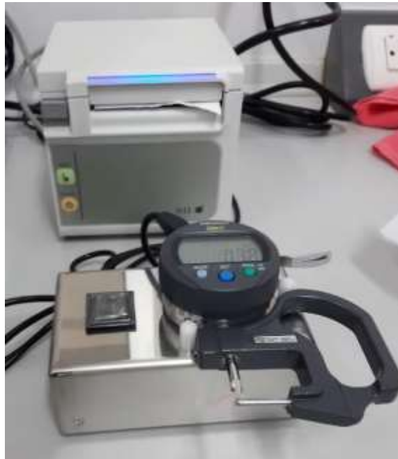
ภาพภาคผนวกที่ 10 เครื่องวัดความหนาเปลือกไข่ไก่ DET6500
