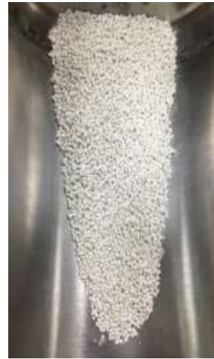
ภาพภาคผนวกที่ 5 การเคลือบเม็ด granule ด้วยพอลิเมอร์ Eudragit® L 100
