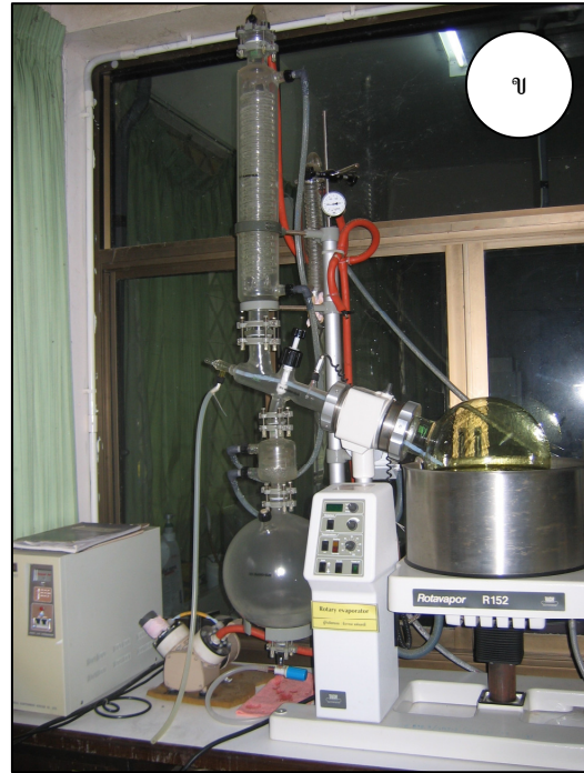
ภาพที่ 3 การแช่เนื้อในเมล็ดสะเดาซึ่งในขวดแก้วขนาด 20 ลิตร (ก) และเครื่องระเหยสุญญากาศแบบหมุน (ข)
