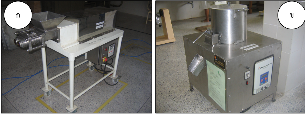
ภาพที่ 4 เครื่อง Extruder (ก) และเครื่อง Spheronizer (ข)
