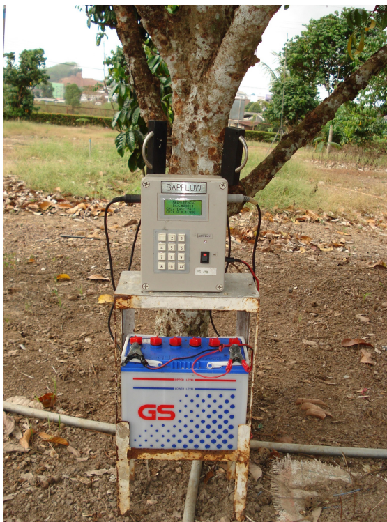
ภาพที่ 13 การติดตั้งเครื่องมือวัดอัตราการไหลของน้ำวัดกับต้นลองกอง
