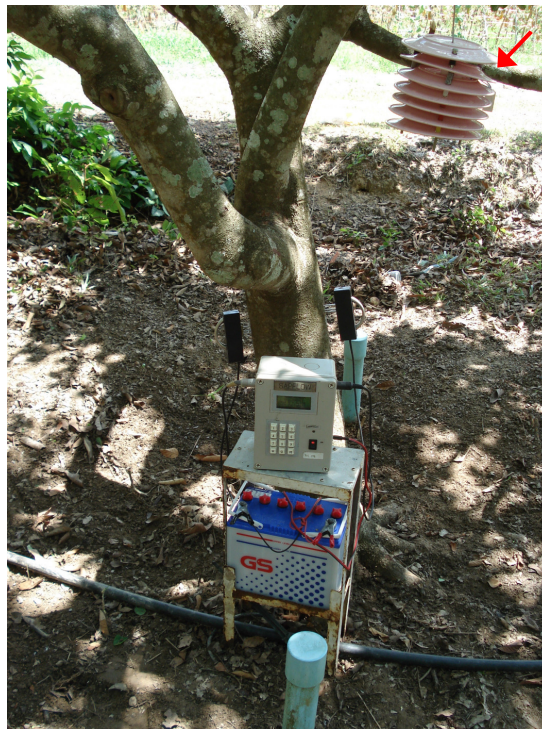
ภาพที่ 12 การติดตั้งไมโครลอกเกอร์วัดความชื้นและอุณหภูมิไว้ภายในทรงพุ่ม
