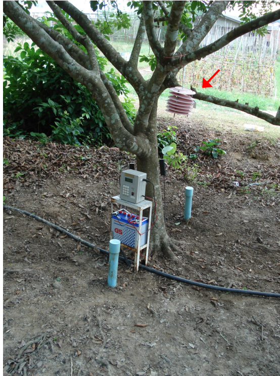
ภาพที่ 11 การติดตั้งเครื่องมือวัดอัตราการไหลของน้ำวัดกับต้นเงาะ
