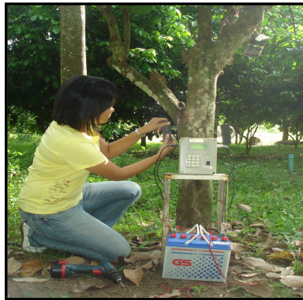
ภาพที่ 16 แสดงการปักหัววัดอัตราการไหลของน้ำในลำต้นด้วยเครื่องมือวัดอัตราการไหลของน้ำแบบพัลส์ความร้อนรุ่น PSU-NRT
