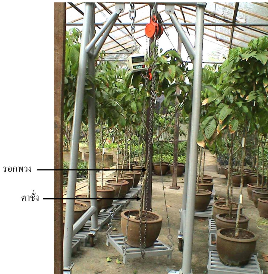
ภาพที่ 6 การใช้รอกพวงเพื่อหาปริมาณการใช้น้ำของต้นลองกองที่ปลูกในกระถางโดยวิธีการชั่งน้ำหนัก (Gravimetric water loss)
