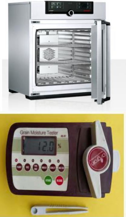
รูปที่ 6.12 เครื่องมือสำหรับทดสอบความชื้นของเมล็ดพันธุ์ ตู้อบลมร้อน (บน) และเครื่องวัดความชื้นแบบดิจิตอล (ล่าง)
